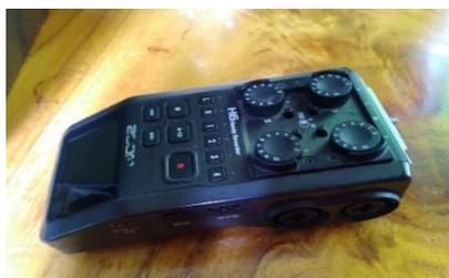
Perangkat perekam dapat menggunakan microphone Zoom H6 MSH-6 MS bawaan untuk merekam teknik Mid-Side dengan menangkap suara langsung (tengah) dengan pola
