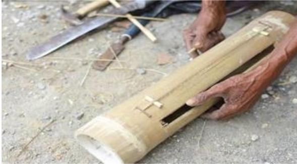
Gambar 14. Sisa pemotongan resonator yang dibagi menjadi dua bagian digunakan untuk penyangga senar
