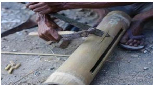
Gambar 12. Proses pembuatan senar pada kulit bambu
