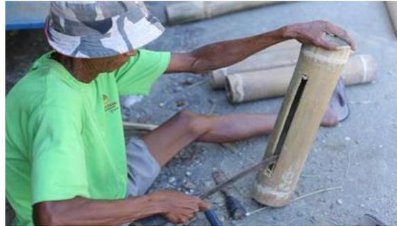
Gambar 9. Proses pembuatan resonator pada bambu
