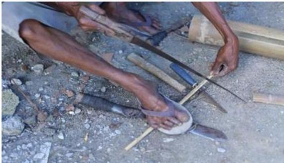
Gambar 10. Pemotongan sisa pembuatan resonator pada bambu
