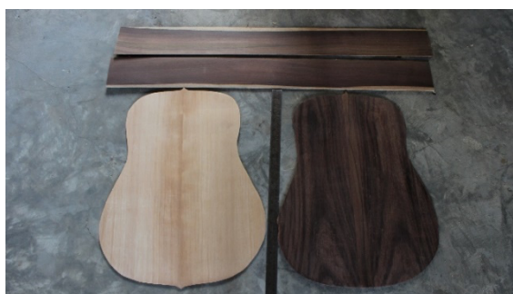
Gambar 5. Keserasian Serat pada Side, Back dan Top Body Gitar (Sumber: Dwi Setyawan, 2023)
