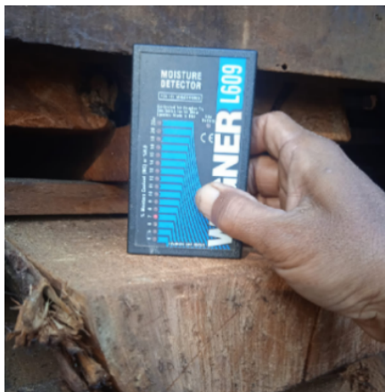
Gambar 4. Moisture Content (MC) Meter (Sumber: Yanto, 2023)
