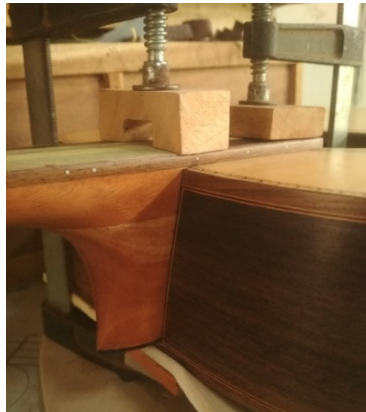
Gambar 24. Proses Joint Neck dengan Body Gitar (Sumber: Dwi Setyawan, 2023)
