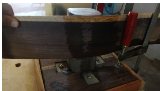
Gambar 15. Proses Bending Side Gitar (Sumber: Dwi Setyawan, 2023)
